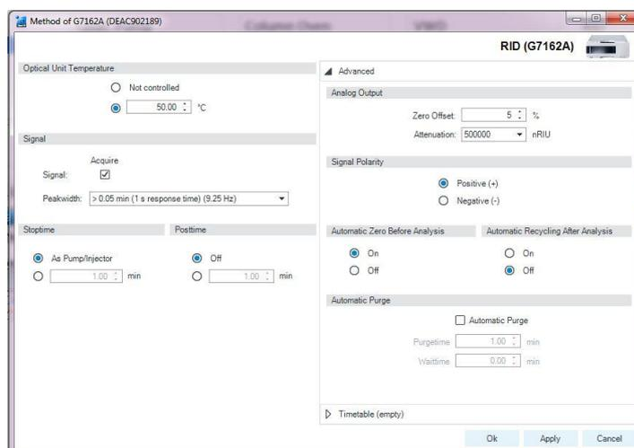
**Fig 6.** RID method parameters
