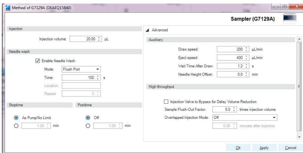
**Fig 2.** Autosampler method parameters
