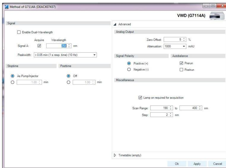
**Fig 5.** VWD method parameters
